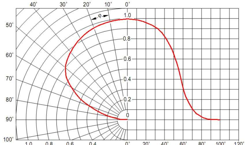
Рисунок 4 Тип КСС в исполнении «Д»
