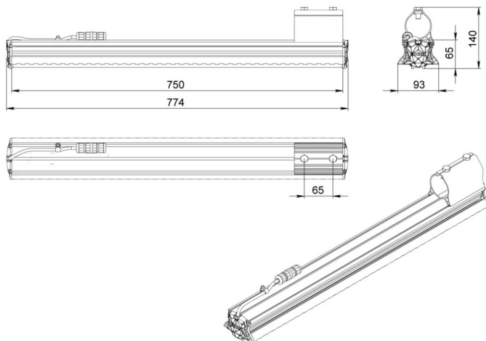
Рисунок 1 Габаритные размеры светильника «L-street 120 Turbine»
