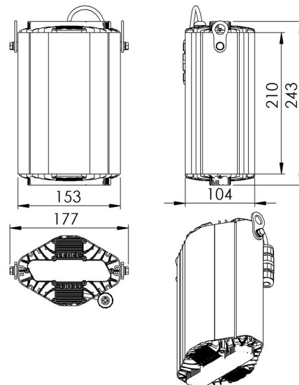
Рисунок 1 Светильник «L-lego II 30» Подвесное крепление.
