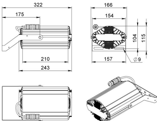
Рисунок 2 Светильник «L-lego II 30 banner» Поворотное крепление
