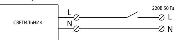
Рисунок 2 Схема подключения светильника «L-office 32»
